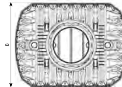
Abbildung zeigt Erdtank Carat mit Tankdom Maxi ohne Abdeckung und Substratfilter Intern. Die gesamte Einbauhöhe ergibt sich aus der gesamten Tankhöhe ( $H_{tot}$ ) zuzüglich dem Teleskop-Domschacht. Seite 189
