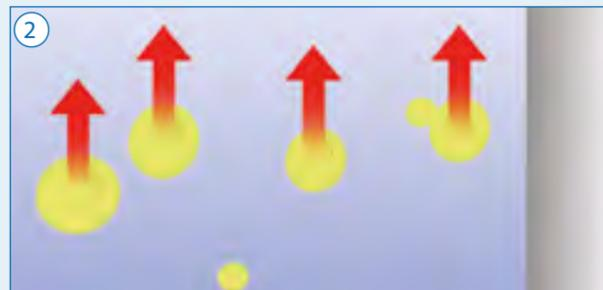
Große Öltröpfchen haben eine hohe Dichtedifferenz zum Wasser, diese steigen auf. Kleine Öltröpfchen haben eine geringe Dichtedifferenz zum Wasser, diese verbleiben unter der Wasseroberfläche.
